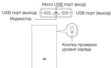
**Примечание:** Кнопка "Проверка уровня заряда" не предназначена для включения/выключения устройства, в устройстве есть автоматическое определение зарядки или разрядки, поэтому нет необходимости постоянно нажимать кнопку "Проверка уровня заряда". За две минуты до разрядки индикатор заряда аккумулятора выключится.
